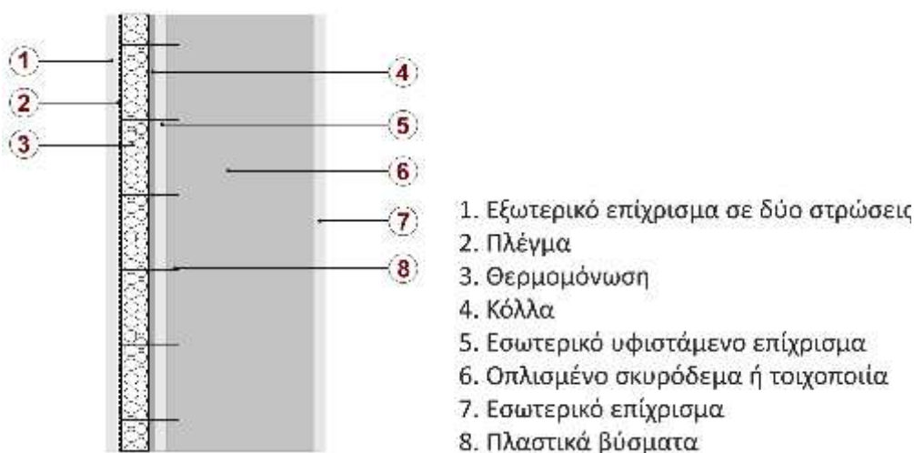
Εικόνα 1: Ενδεικτική τομή εξωτερικής θερμομόνωσης
