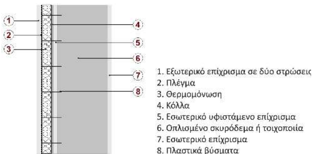
Εικόνα 1: Ενδεικτική τομή εξωτερικής θερμομόνωσης
